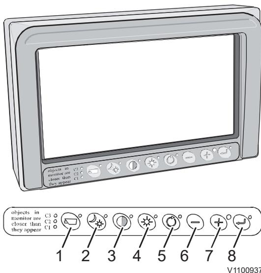
Bei Drücken der Taste 5 "Alternative" wird eine Abbildung (Standbild) von der angeschlossenen Kamera erzeugt. Die Anzeigedauer des Standbildes kann eingestellt werden. Der Alarm vom Radarerfassungssystem wird auch vorübergehend ausgeschaltet, wenn die Taste eingedrückt wird.
