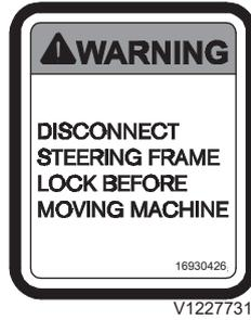
39 Vor dem Bewegen der Maschine Knickgelenksperre entfernen (nur USA)
