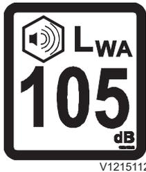
10 Schallleistungspegel außerhalb der Maschine
